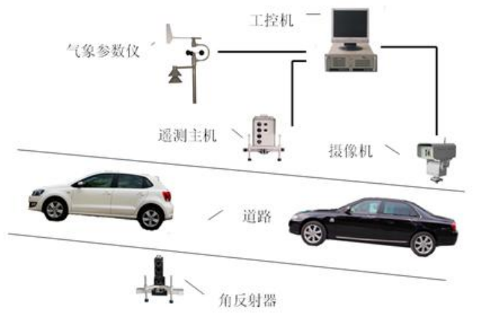
图 6-4 水平式尾气遥测设备安装示意图
